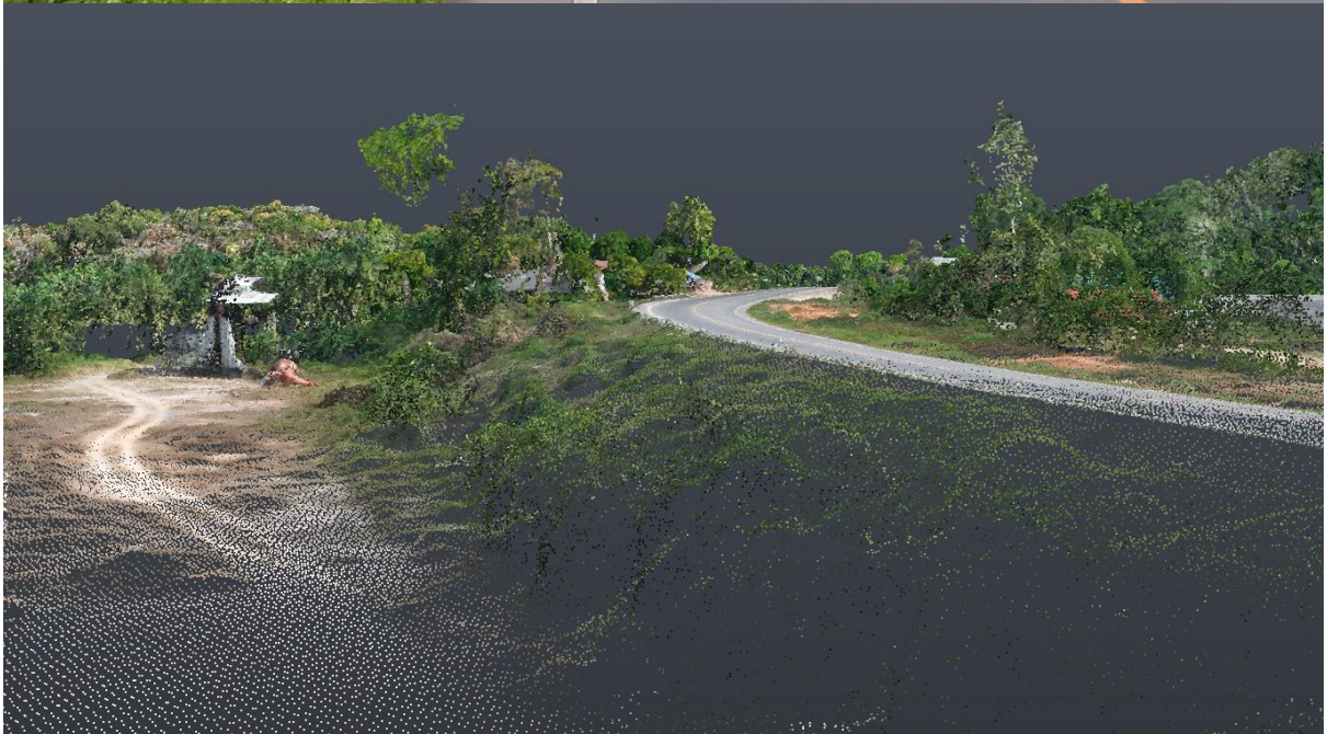
รูปที่ 5-8 พื้นที่ที่ 4 ลักษณะภูมิประเทศที่เป็นคันทางต่างระดับ เขตทางกว้าง 40 เมตร
