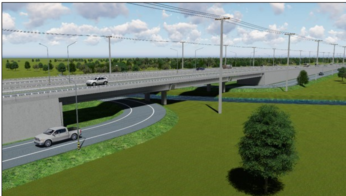
รูปแบบที่ 3 : จุดกลับระดับได้สะพาน รูปที่ 6.3-2 รูปแบบจุดกลับ
